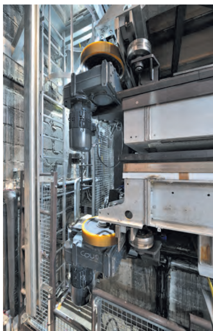
Vue en détail des galets d'entraînement des plateaux mobiles
