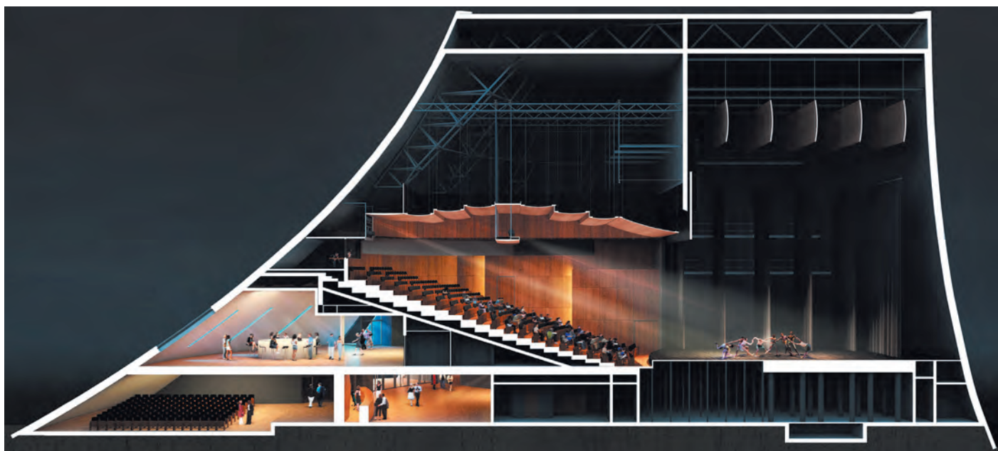
Configuration théâtre avec plafond de salle fermé - Document © Rémi Raskin
