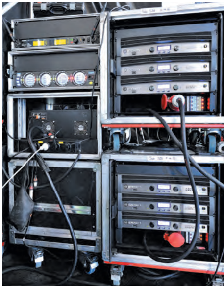
Scène Automne, amplification façade Crown Audio I.Tech 12000 HD, contrôleur Dobby Lake Processor LP4D12
