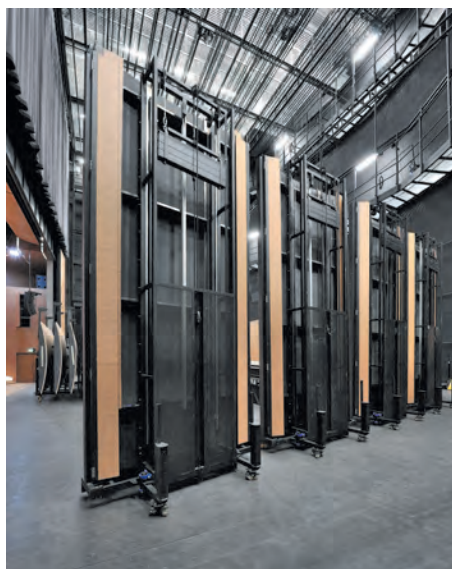
Murs télescopiques latéraux contrebalancés de la conque
