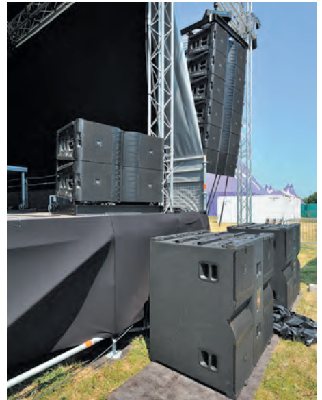
Scène Printemps, diffusion façade JBL VTX V25-II, renforts de graves JBL S28
