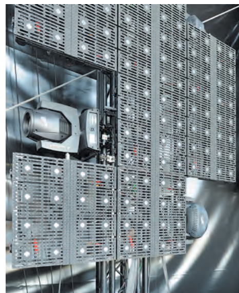
Scène Hiver, projecteurs Clay Paky Sharp, panneaux LEDs ROE Visual Hybrid 18
