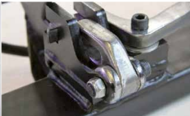
Gâchette principale retenue par le marteau - Photo © CATS
