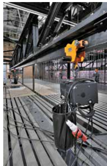
Nouveau système de chariots porte-palans à poussée manuelle
