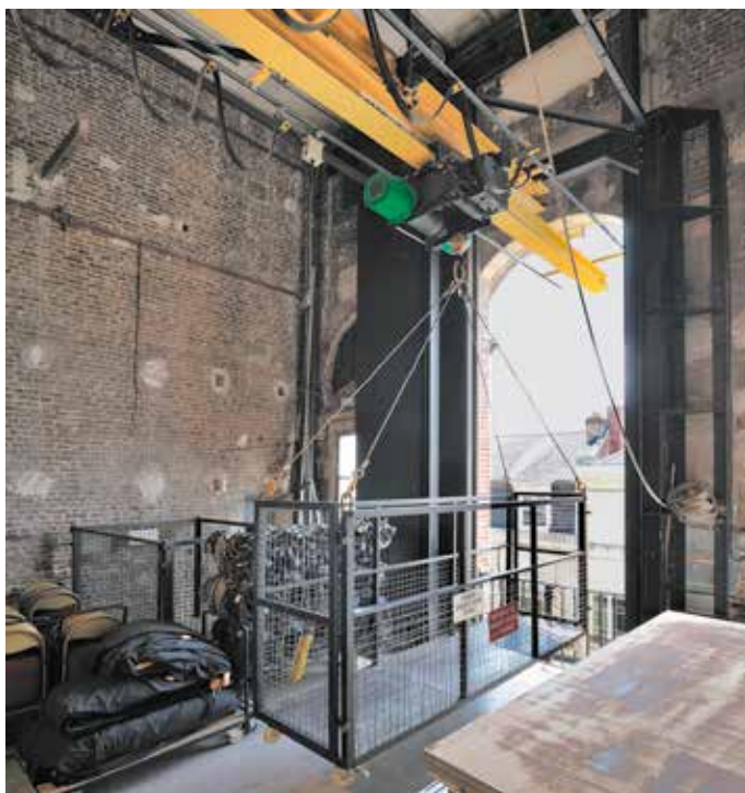
Le dispositif de treuillage des décors depuis la rue située 7 m en contrebas
