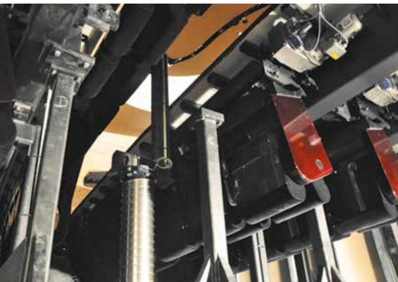
Le système Gala permettant de rabattre les fauteuils du gradin
