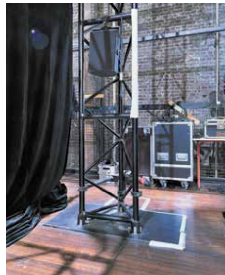
Enceinte side fill d&b audiotechnik E6 fixée sur lyre orientable sur une tour de levage Stacco
